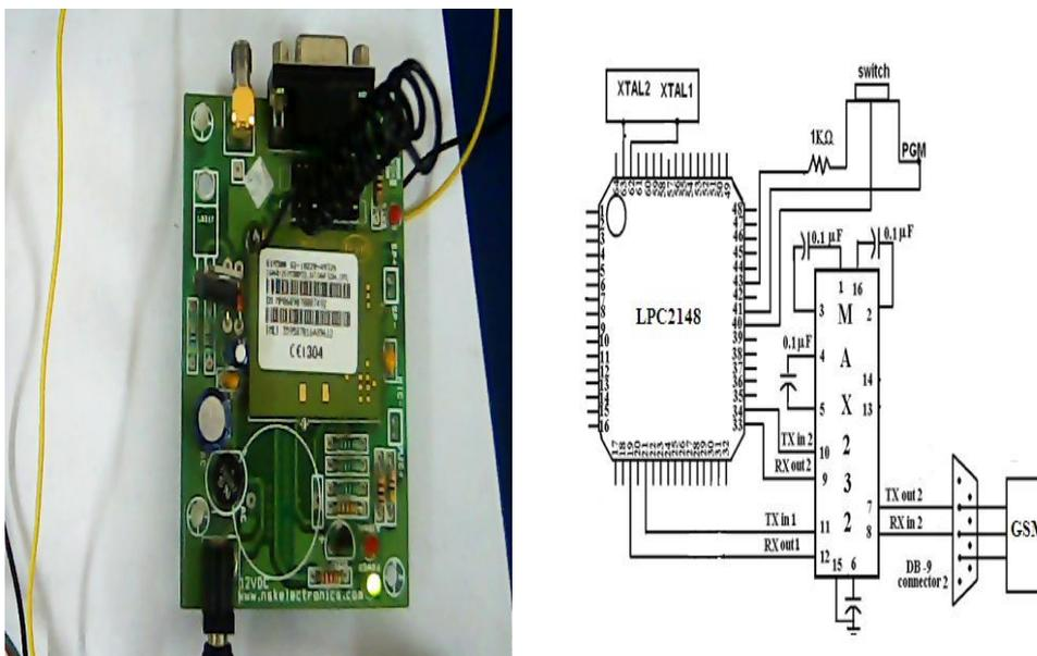
Fig5. SIM900 GSM MODULE
