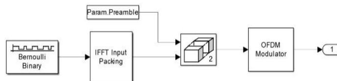
Figure4. MC-CDMA Transmitter Model
